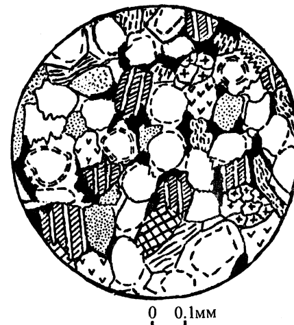
Рис. 6.16. Структура песчаников триаса с «ажурным» скелетом за счет образования соединительных мостиков кварцевого состава (черное — поры) (по Япаскурту)
