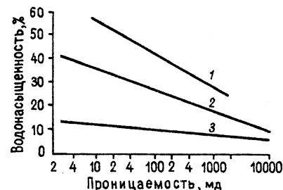
Рис. 6.14. Графики зависимости проницаемости от водонасыщенности (по Черникову): 1 — алевриты, 2 — мелкозернистый песчаник, 3 — среднезернистый песчаник
